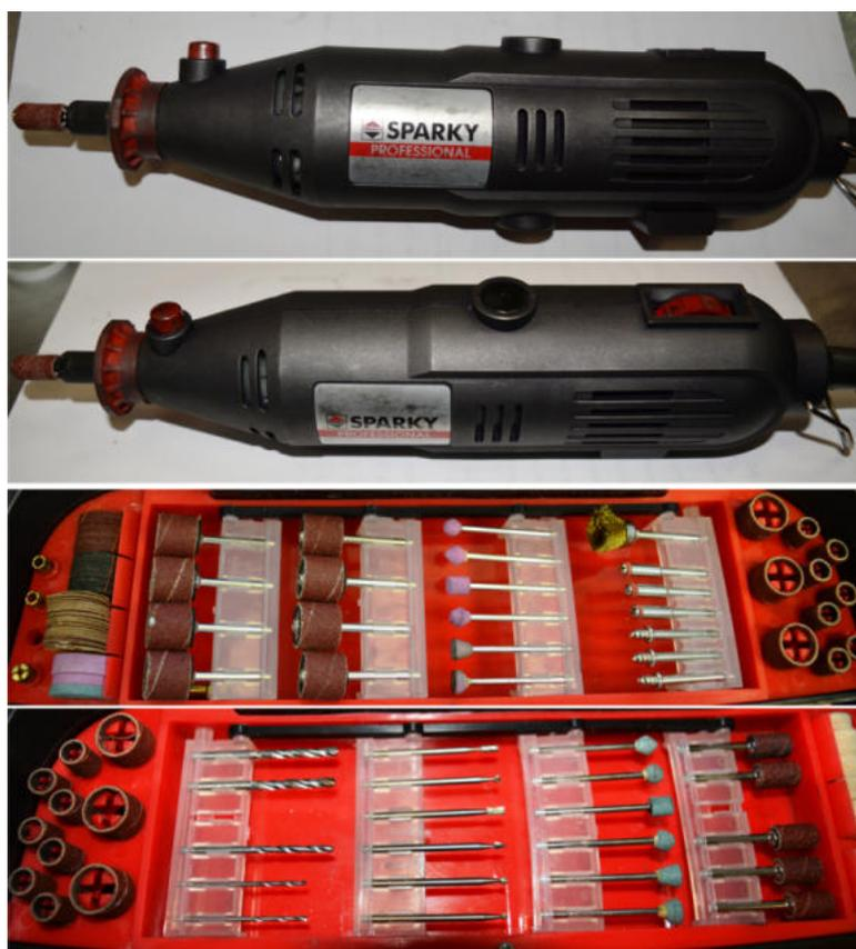
Рисунок 2.3.4. – Устройство для изготовления графитовых включений и наборы насадок для обработки
