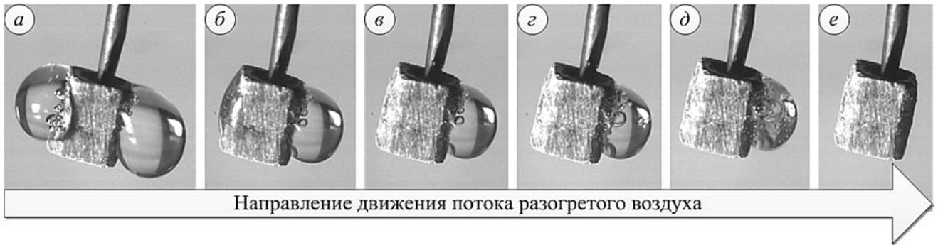
Рисунок 3.9.2. – Типичные кадры видеogramм процессов испарения и кипения двух капель воды (начальный объем капель 7 мкл) с поверхности графитового включения (характерный размер 2 мм) в разные моменты времени при температуре воздуха  $T_g=623$  К: *a* – 6 с; *б* – 14 с; *в* – 15 с; *г* – 16 с; *д* – 18 с; *е* – 22 с
