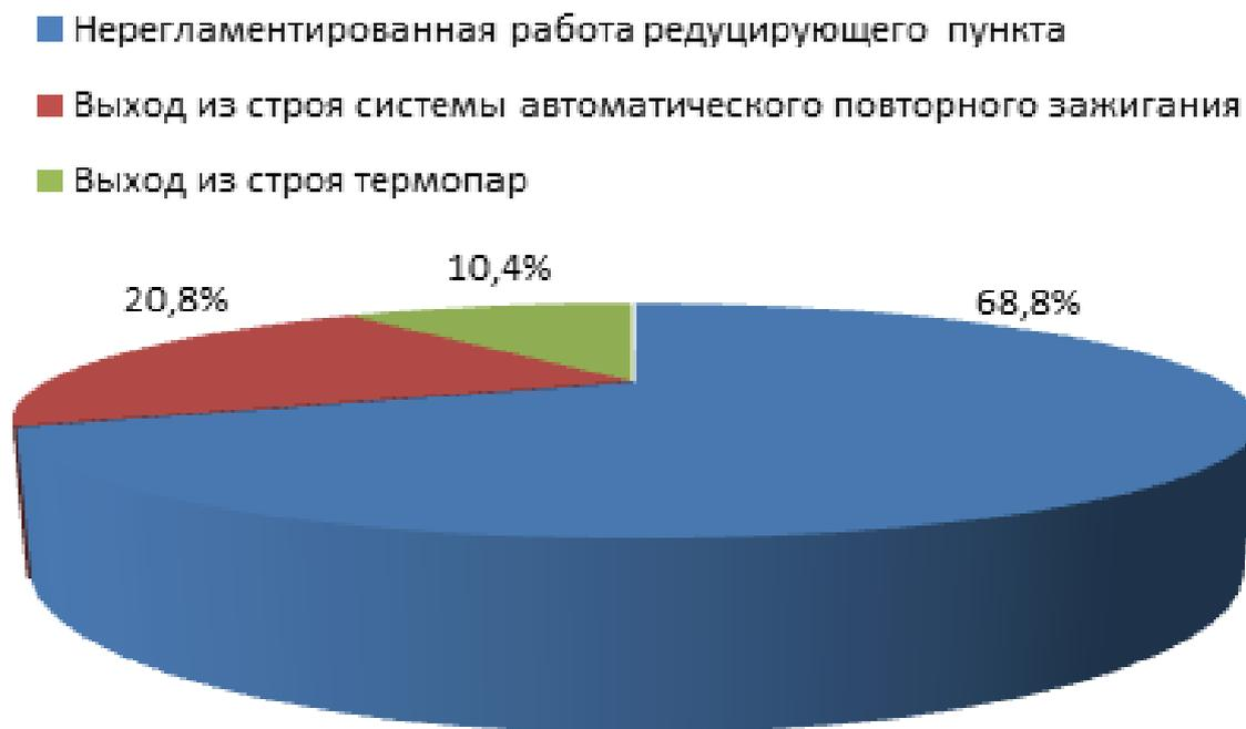
Рисунок 2.4.1.1. Соотношение различных причин аварийного технического происшествия «обрыв пламени горелочного устройства»
