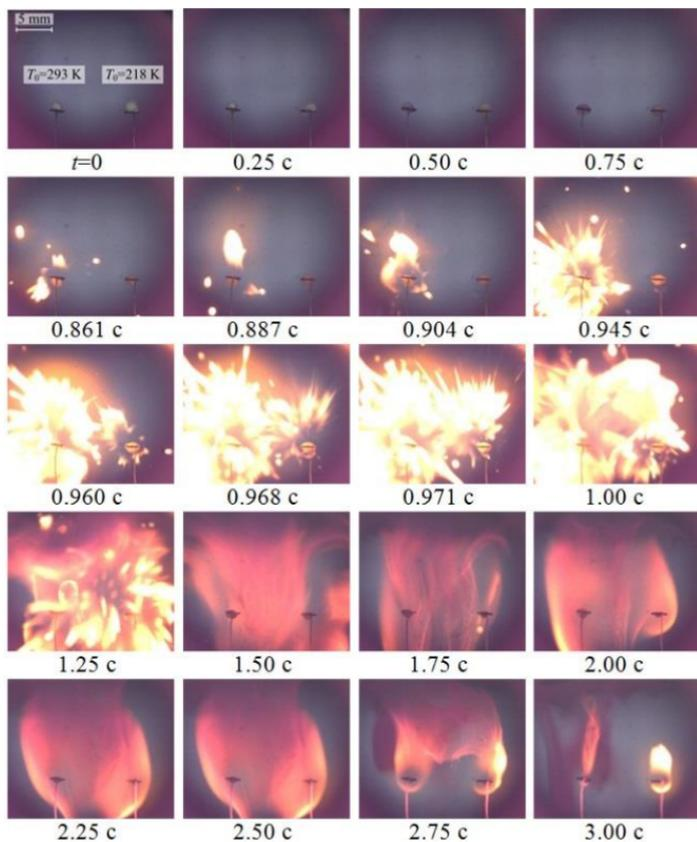
Рисунок 2. Кадры зажигания образцов гелеобразного топлива с разной начальной температурой при  $T_g = 1073 \text{ K}$
