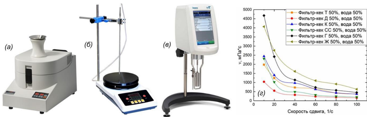
Рис. 2.1. Оборудование (а – роторная мельница, б – магнитная мешалка, в – вискозиметр) и типичные зависимости динамической вязкости от скорости сдвига для фильтр-кеков разных марок каменных углей (z)
