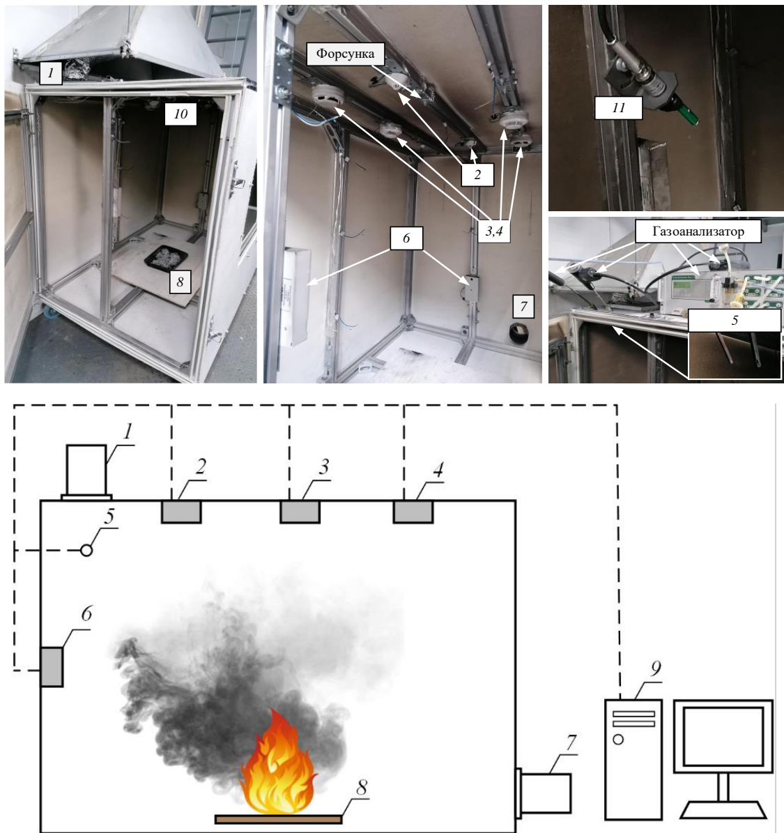
Рисунок 3.7 – Внешний вид схема и экспериментального стенда: 1 – выход системы вентиляции; 2 – тепловой пожарный извещатель; 3 – дымовой беспроводной пожарный извещатель; 4 – дымовой проводной пожарный извещатель; 5 – место размещения зонда газоанализатора; 6 – пожарный извещатель пламени; 7 – вход системы вентиляции; 8 – модельный очаг пожара; 10 – видеокамера; 11 – пирометр
