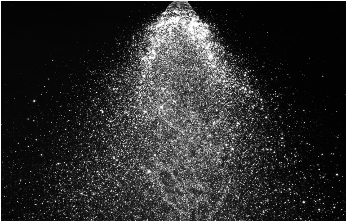
Рисунок 2.3.1.3. Типичная видеogramма потока капель распыленной жидкости в проведенных экспериментах
