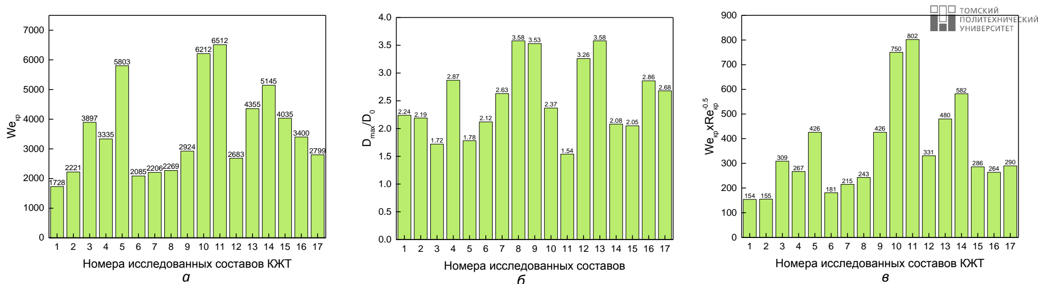
Рис. 23. Значения критических чисел Вебера ( a ), увеличения диаметра капли относительно исходного ( b ), произведения критических значений критериев Вебера и Рейнольдса ( v ), соответствующие условиям фрагментации капель топливных суспензий: 1 - Фильтр-кек угля марки Д 50%, вода 50%; 2 - Фильтр-кек угля марки Д 40%, вода 60%; 3 - Каменный уголь марки Д 50%, вода 50%; 4 - Каменный уголь марки Д 40%, вода 60%; 5 - Каменный уголь марки Д 45%, вода 55%; 6 - Бурый уголь марки Б2 40% (80 мкм), вода 60%; 7 - Бурый уголь марки Б2 40% (100 мкм), вода 60%; 8 - Бурый уголь марки Б2 40% (140 мкм), вода 60%; 9 - Фильтр-кек угля марки Д 50%, вода 47.5%, турбинное масло 2.5%; 10 - Фильтр-кек угля марки Д 50%, вода 50%, турбинное масло 5%; 11 - Фильтр-кек угля марки Д 50%, вода 40%, турбинное масло 10%; 12 - Фильтр-кек угля марки Д 37%, вода 61%, древесные опилки 2%; 13 - Фильтр-кек угля марки Д 35%, вода 61%, древесные опилки 4%; 14 - Фильтр-кек угля марки Д 50%, вода 45%, арахисовая шелуха 5%; 15 - Каменный уголь марки Д 50%, вода 49.75%, неонол 0.25%; 16 - Каменный уголь марки Д 50%, вода 49%, неонол 1%; 17 - Каменный уголь марки Д 50%, вода 49.75%, твин 0.25%; 18 - Каменный уголь марки Д 50%, вода 49.5%, кукурузный крахмал 0.5%.
