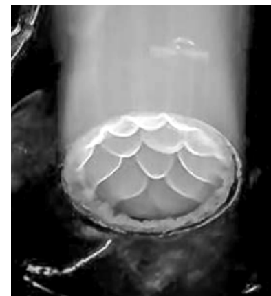
Ячеистое пламя (богатая смесь пропан-бутан + воздух)
