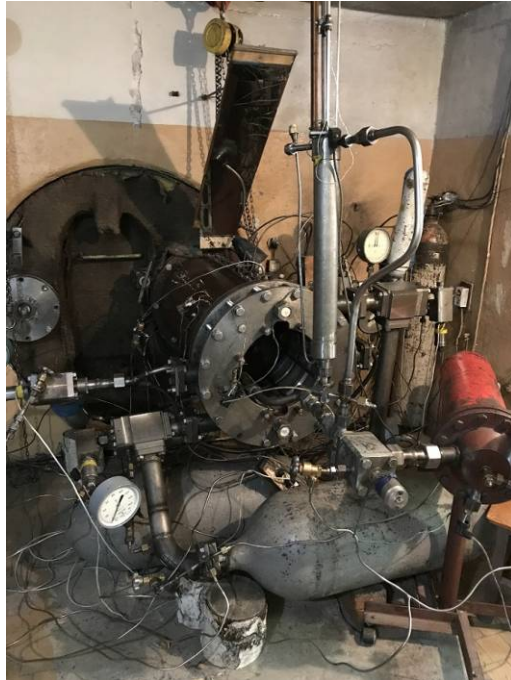
Экспериментальный стенд с детонационной камерой сгорания (ДК-500)
