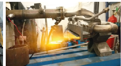
Канал с перепуском детонации в полуограниченный объем
